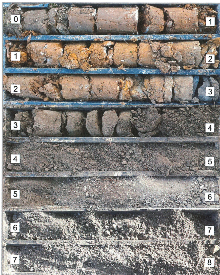
Foto 1: Geologické jadro (vrtný profil) z vrtu IGMS - 1
