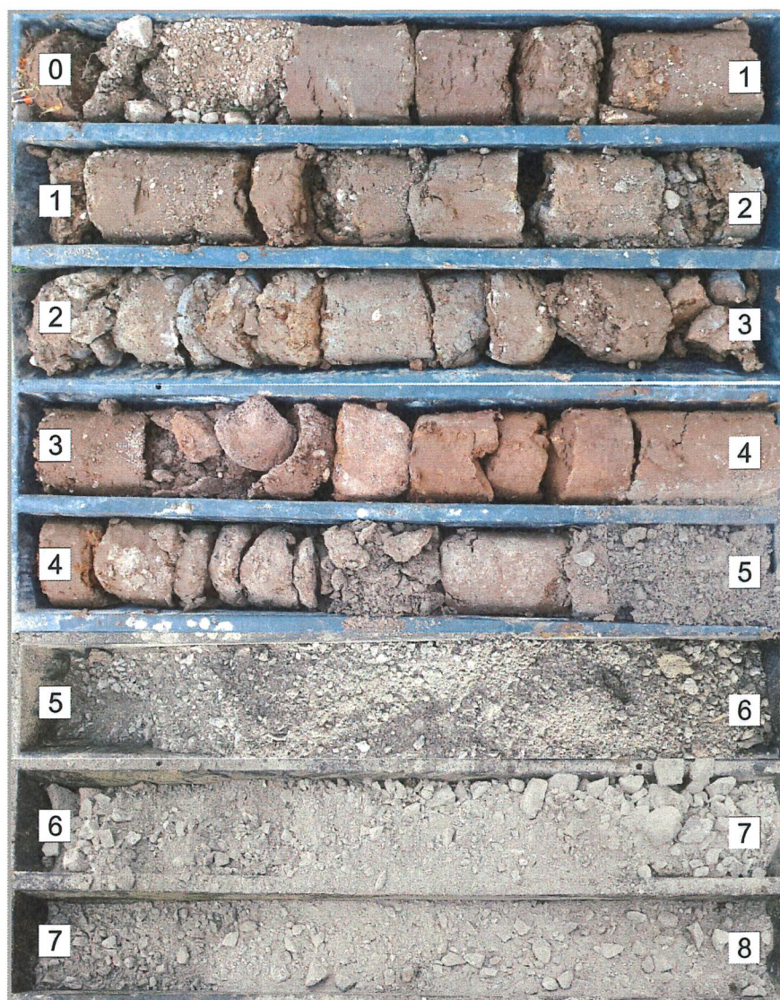
Foto 1: Geologické jadro (vrtný profil) z vrtu IGP - 1
